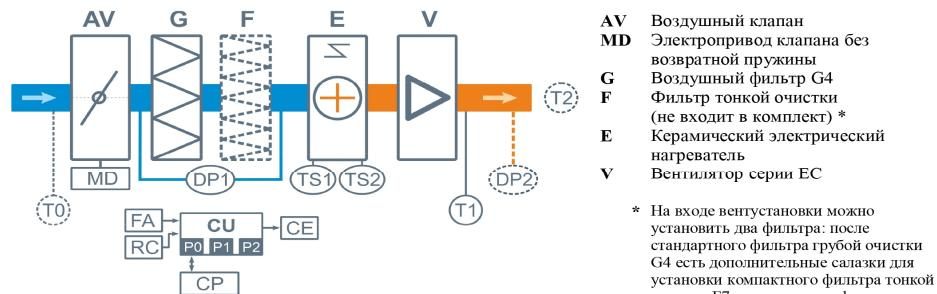
\* На входе вентустановки можно установить два фильтра: после стандартного фильтра грубой очистки G4 есть дополнительные салазки для установки компактного фильтра тонкой очистки F7 или угольного фильтра.
